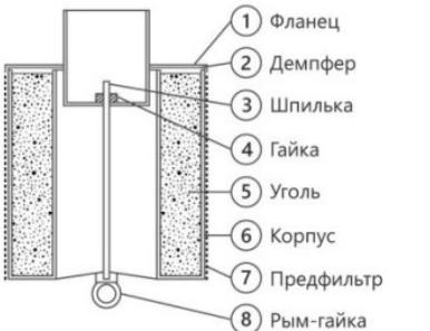
**РАЗБИРАЕМ:** Устанавливаем фильтр в вертикальное положение, фланцем (1) вверх. Снимаем предфильтр (7). Скручиваем гайку (4) и снимаем фланец. Вынимаем паралоновый демпфер (2) и приподняв фильтр, удаляем шпильку (3) с рым-гайкой (8). Затем удаляем переработанный уголь, перевернув корпус на 180 градусов.
